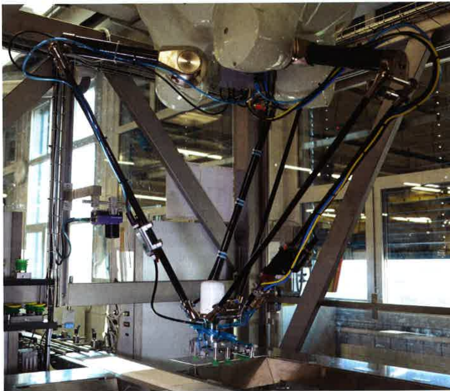
Zunehmend selbst lernende Bildverarbeitungssysteme erhöhen in Kombination mit einem Pick & Place Roboter die Durchlaufzeit und übernehmen die Qualitätskontrolle
